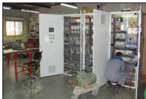
Montage et essai d'une armoire d'automatisme
